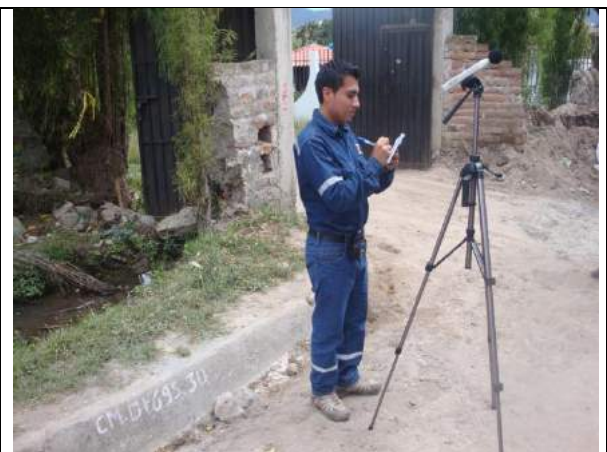
Fotografía 7. Registro de los niveles de ruido
